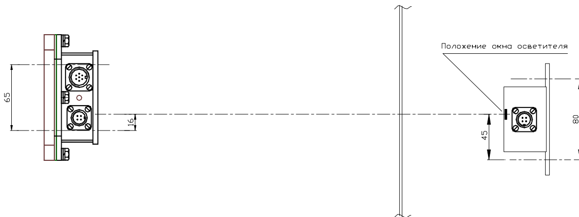
Рисунок 5 - Расположение осветителя ОС относительно блока по оси Z
