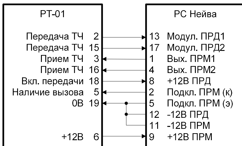
Рисунок 2. Подключение радиостанции «Нейва-РД»
