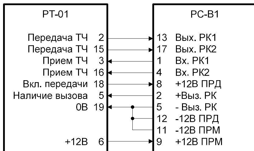
Рисунок 3. Подключение радиостанции «РС-В1»
