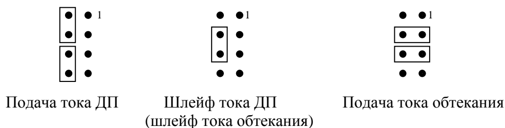
Рис. 4. Установка перемычек на платах ЛТ для четырехпарного двухкабельного режима
