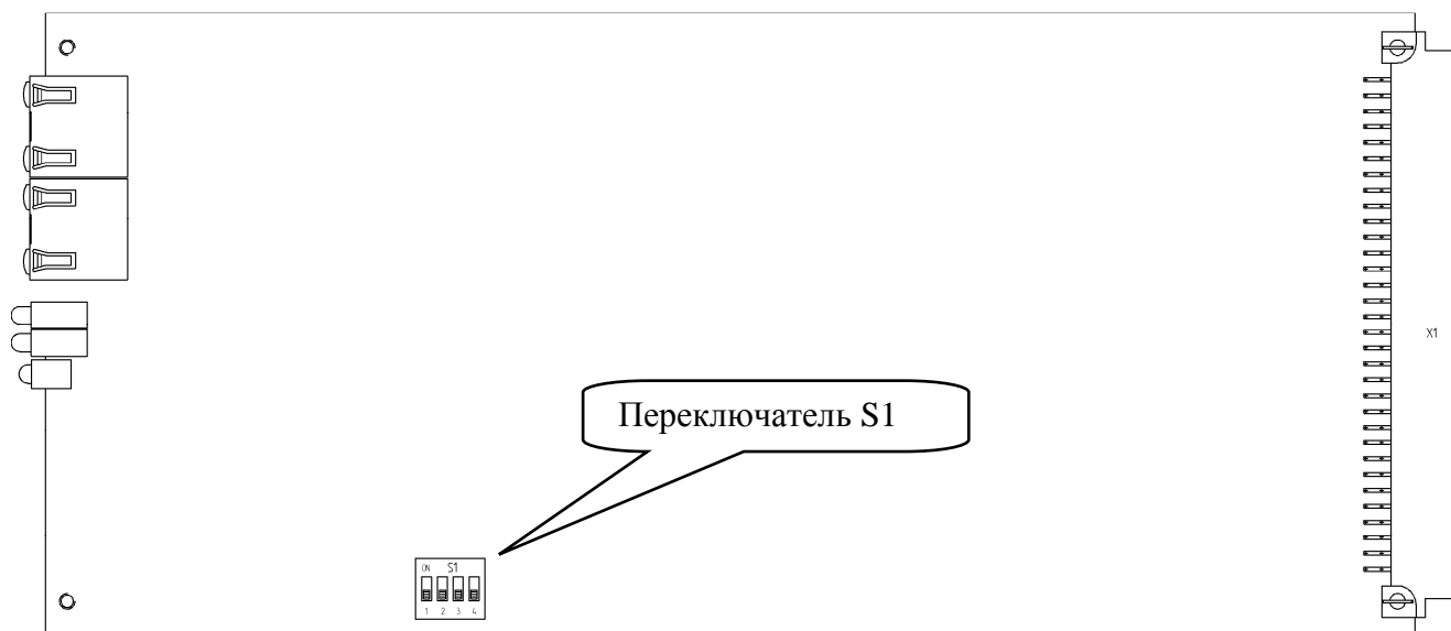
Рис. 2. Вид платы КМ-15 сбоку
