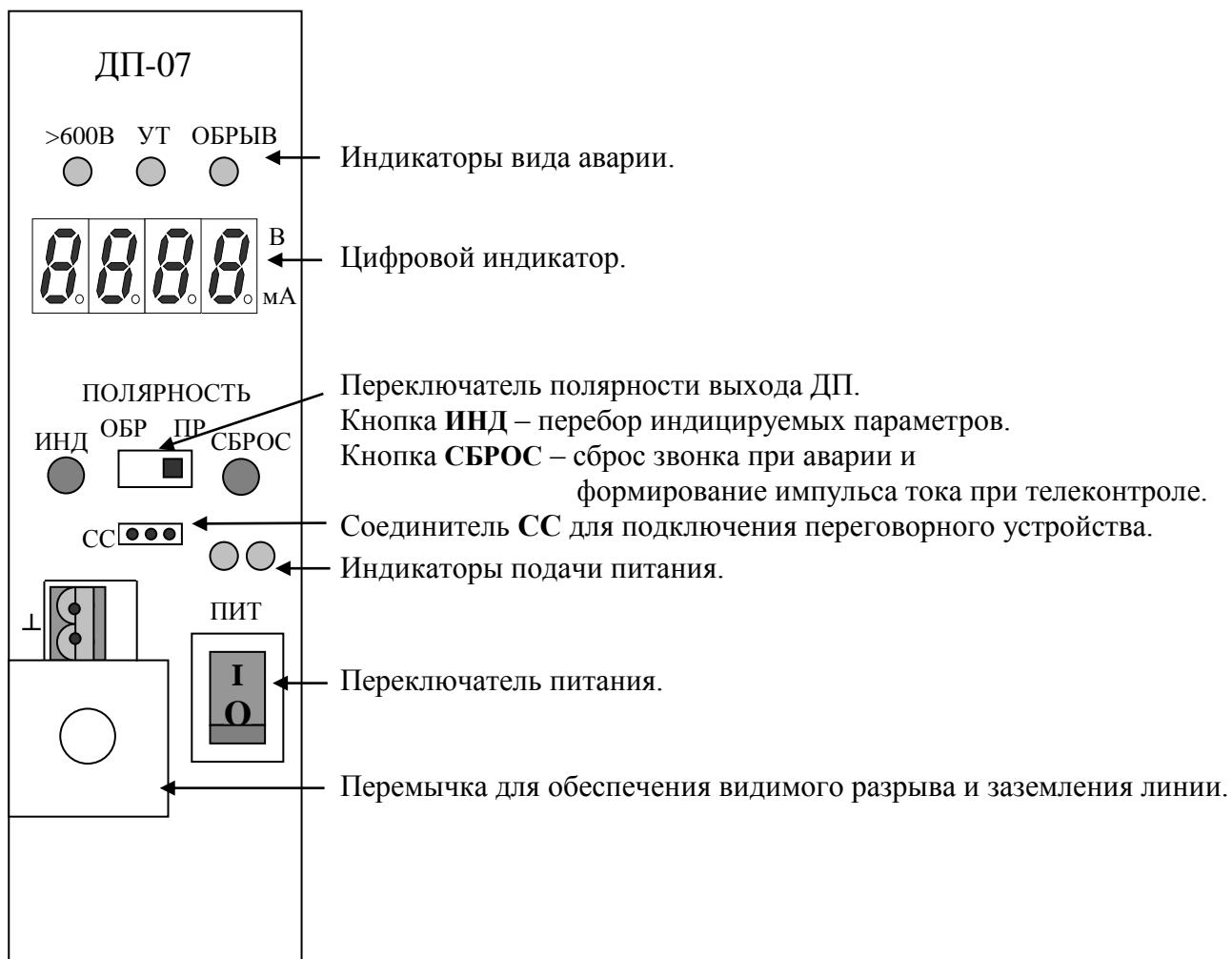
3.2. Аппаратная часть платы содержит следующие функциональные узлы:
